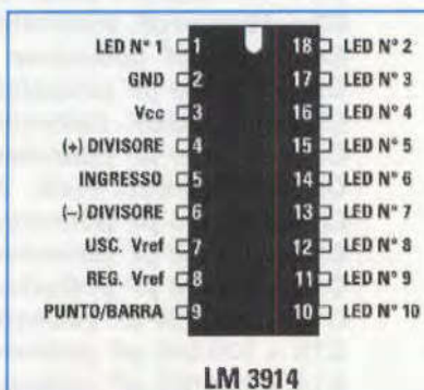
Fig.6 Connessioni dell'integrato LM.3914 che pilota 10 diodi led in modalità scala continua o, come in questo caso, in modalità punto. Connessioni viste frontalmente e dall'alto della barra led da 5 diodi: il terminale Anodo è sempre più lungo del terminale Katodo.
